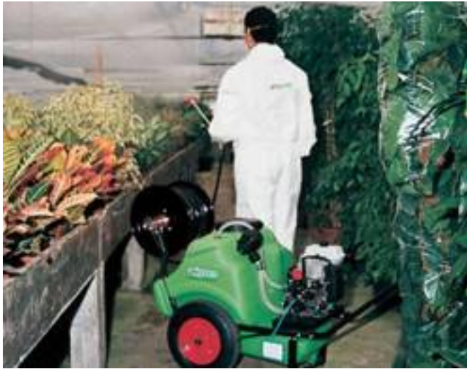
I piccoli irroratori a spinta Unigreen funzionano con motore a scoppio o elettrico e sono adatti per situazioni particolari, come la serra per vasi che vediamo in questa foto.
