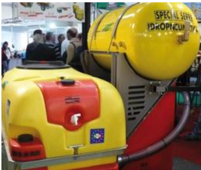
Dsm Special 500: macchina composta da cisterna tradizionale e pompa con collettore che si aggancia a un impianto d'irrorazione.
