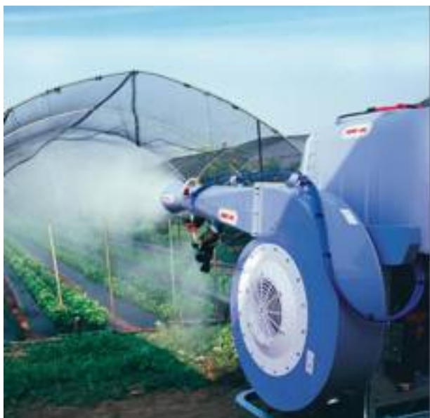
Ideal Mig, il cannone della Ideal. Si può controllare dal posto di guida, con angolo di rotazione di 120°.
