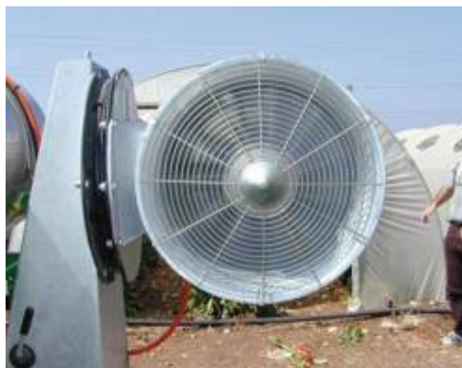
Uno dei metodi più usati per il trattamento delle serre prevede l'irrorazione dall'esterno attraverso un cannone con gittata che può raggiungere i 50 m.
