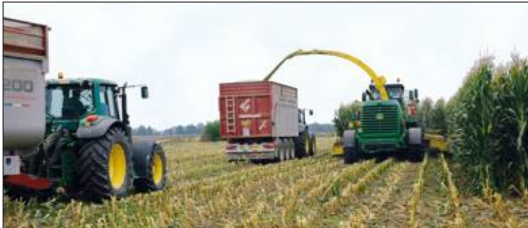
[ La trincacaricatrice John Deere della serie «i» Prodrive dispone di un vero spettroscopio portatile , in grado di effettuare analisi complesse del prodotto raccolto.
